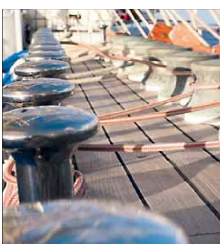
In Reih' und Glied stehen die Krampen, auf denen die Schoten belegt werden.
