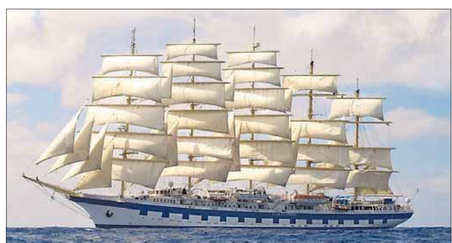
Die „Royal Clipper“ unter Vollzeug: 5050 Quadratmeter verteilen sich auf 42 Segel, jedes hat einen Namen. Das Kreuz-Obermarssegel fehlt, es wird repariert.
